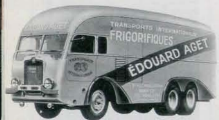
Un frigorifique de 45 m 3 monté sur un « R15 ».
