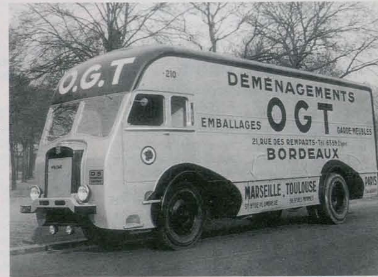
Ci-dessus, un fourgon de déménagement composé d'un châssis « L 10 » et d'une carrosserie « A » avec sa cabine à poste de conduite avancée. Ci-dessous, une version du célèbre tracteur « Liberty » équipé du système « wagon-rail-route » de Willème-Coder, en gare de Conflans-Ste-Honorine, dans les années 30.
