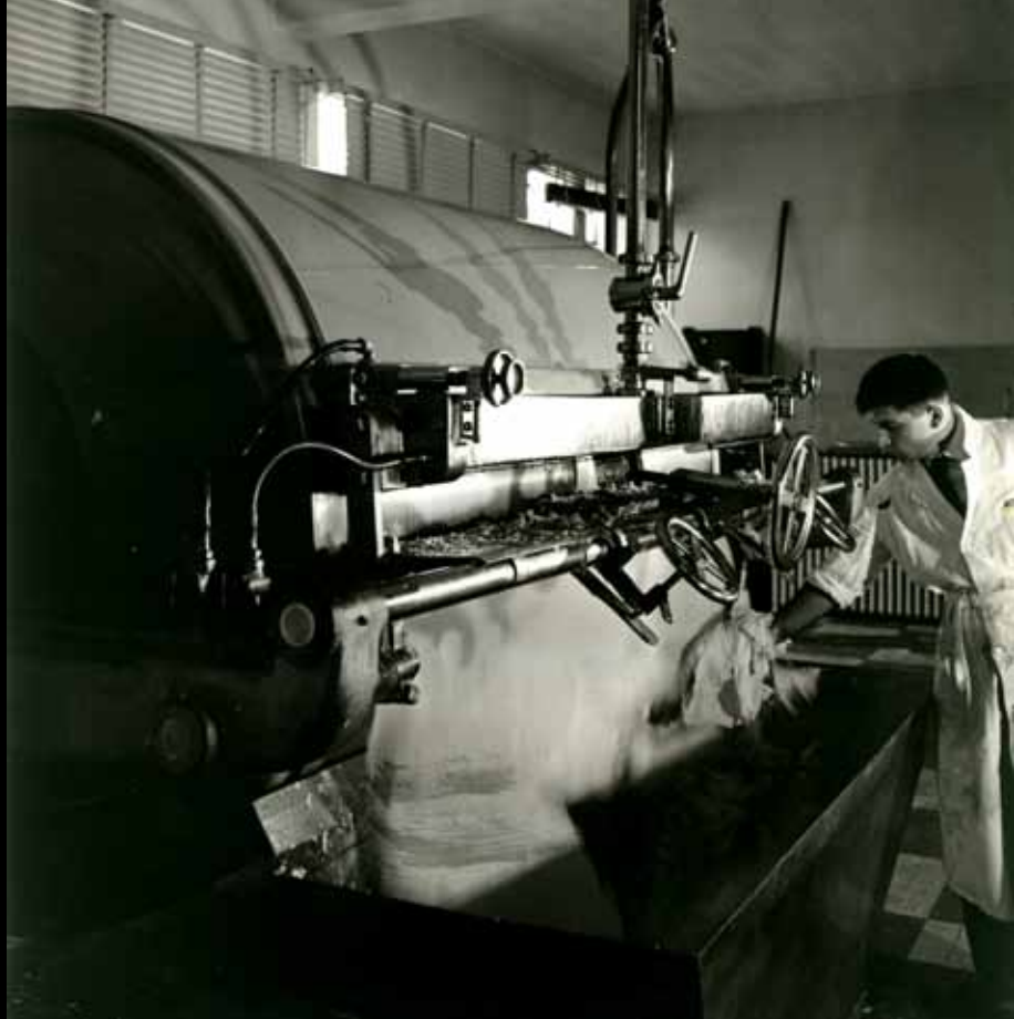
Un tambour dans lequel se produit la cristallisation.
