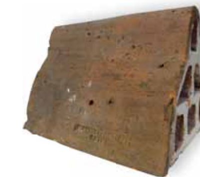
Brique-chaperon posée au sommet d'un mur de clôture, boulevard du Couchant.
