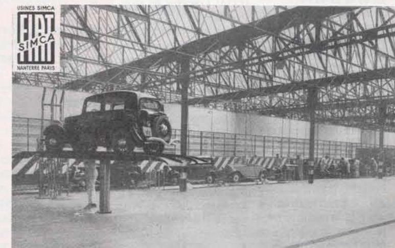
Contrôle et dernières retouches sur la chaîne d'assemblage de la carrosserie.
