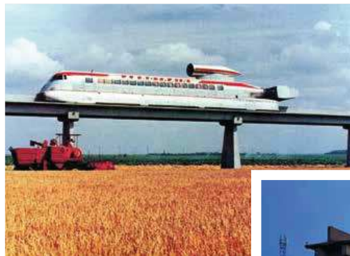
L'Aérotrain circule sur une voie spéciale en forme de T inversé.
